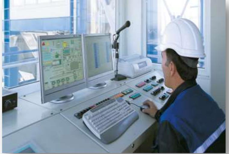
**النظام الإلكتروني و قاعدة البرمجة:** يشغل مصنع الخرسانة إلكترونيا و فل اتوماتيكي عن طريق لوحة التحكم باللمس. تتم عمليات التحكم عن طريق (plc-siemens) يوجد عنده تنبيه بالنسبة لارتفاع نسبة الوزن و معايير بواسطة مستوى العالي لبرنامج plc وأخطاء التحكم في algoritma
