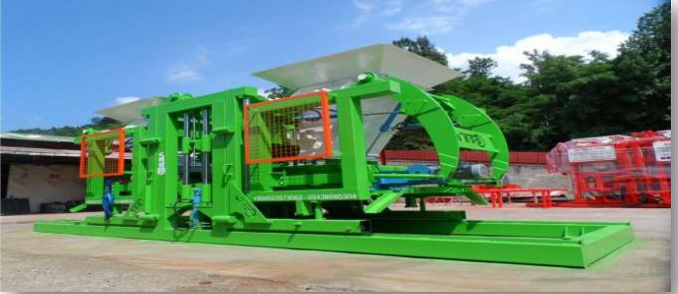
**عدد الهزاز السفلي : 4\*7.5 كيلوات** بمحرك تركيب خاص سيرفو- محرك (فيبرو) // **هزاز التبريد**: لانها مصنوعة من امبير منخفض و لذلك لا يمكن ان يرتفع درجة حرارته / **عدد الهزاز العلوي** : محرك خاص (فيبرو) بقوة 4\*2.2 (كيلوات) // قدرة تبريد الهزاز: 22.000(كجال) // جميع الهزازات: يعطي للمكيينة اهتزاز بذبذبة قليلة من اجل التخמיד ، يحصل على الخמיד بواسطة الكوتشوك لمطاطة والنوابض.
