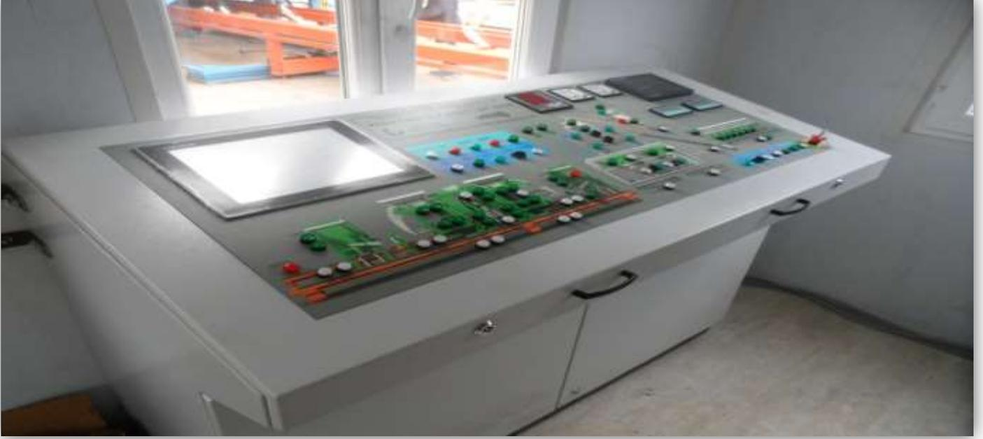
عبارة عن ام المصنع والتشغيل كاملا . جميع حركات الماكينة تتم عن طريق تحكم بأيايدي هيدروليكية . وجميع الوحدات بها حماية عالية. داخل الوحدة يوجد مراوح ضد الرطوبة. قطع الغيار المستعملة جميعها من نوع (SIEMENS-TELEMECHANIC) حسب الطلب الاختياري يمكنكم استخدام (WIFI) للتدخل الخرجي. تم البرمجة على اساس تثبيت العطل و يمكن التدخل من الخارج للصيانة والتعديل . يوجد ازرار توقيف في حالات الطوارئ،ربوطات الماكينة تاخذ الاوامر كلها عن طريق (PLC) .
