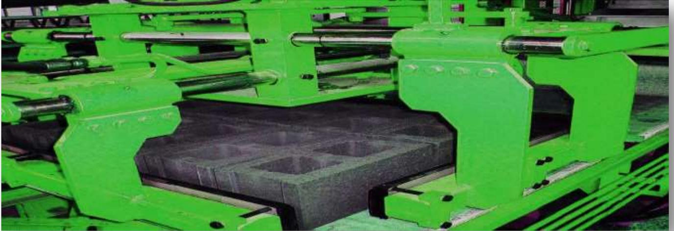
مهمتها تجميع المنتج الجاف وتستيفها على ظهر يورو باليت للتسويق ، لها ميزة حركة 360 درجة التحريك بواسطة نظام ضغط هواء الذي يساهم في عدم تكسير الحجر وتتحرك افقي وسفلي و يمين يسار بقوة محرك (محرك سيرفو)، افقي وسفلي 15 (كيلوات) يمين يسار 5.5 (كيلوات) و يقوم بتحريك الرأس بقوة 3(كيلوات) يقوم بقياس الإرتفاع عن طريق مقياس حساس ليزري.
