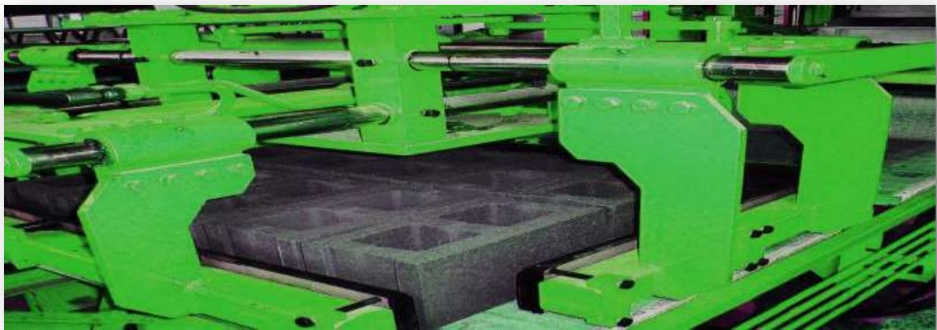
مهمتها تجميع المنتج الجاف وتستيفها على ظهر يورو باليت للتسويق ، لها ميزة حركة 360 درجة التحرير ب بواسطة نظام ضغط هواء الذي يساهم في عدم تكسير الحجر وتتحرك افقي وسفلي و يمين يسار بقوة محرك (محرك سيرفو)، افقي وسفلي 11 (كيلووات) يمين يسار 4 (كيلووات) و يقوم بتحريك الراس بقوة 2.2(كيلووات) يقوم بقياس الارتفاع عن طريق مقياس حساس ليزري
