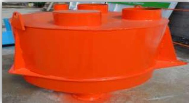
يتواجد في منتصف الخلطات لكي نتمكن من اضافة المواد المطلوبة للخلطات المختارة، وتحرك يمين يسار اسفل حزونه الاسمنت وظيفتها وزن كل من الاسمنت والطلاء والمواد الاضافية ، يتم عملية الوزن عن طريقة خلية تحمل عدد 3 (LOADCEL) كل منها 容量 1000 كجم ، طقطقة المشغل الميكانيكي نوع (WAM) ويستخدم فيها مفتاح صغير . وزن الماء عن طريق عداد الكتروني تصب الماء حسب المنظومة المسجلة اما وزن المواد الاضافية سعة دلو الميزان 100 كجم و خزان وزن الصباغة 150 كليوغرام.
