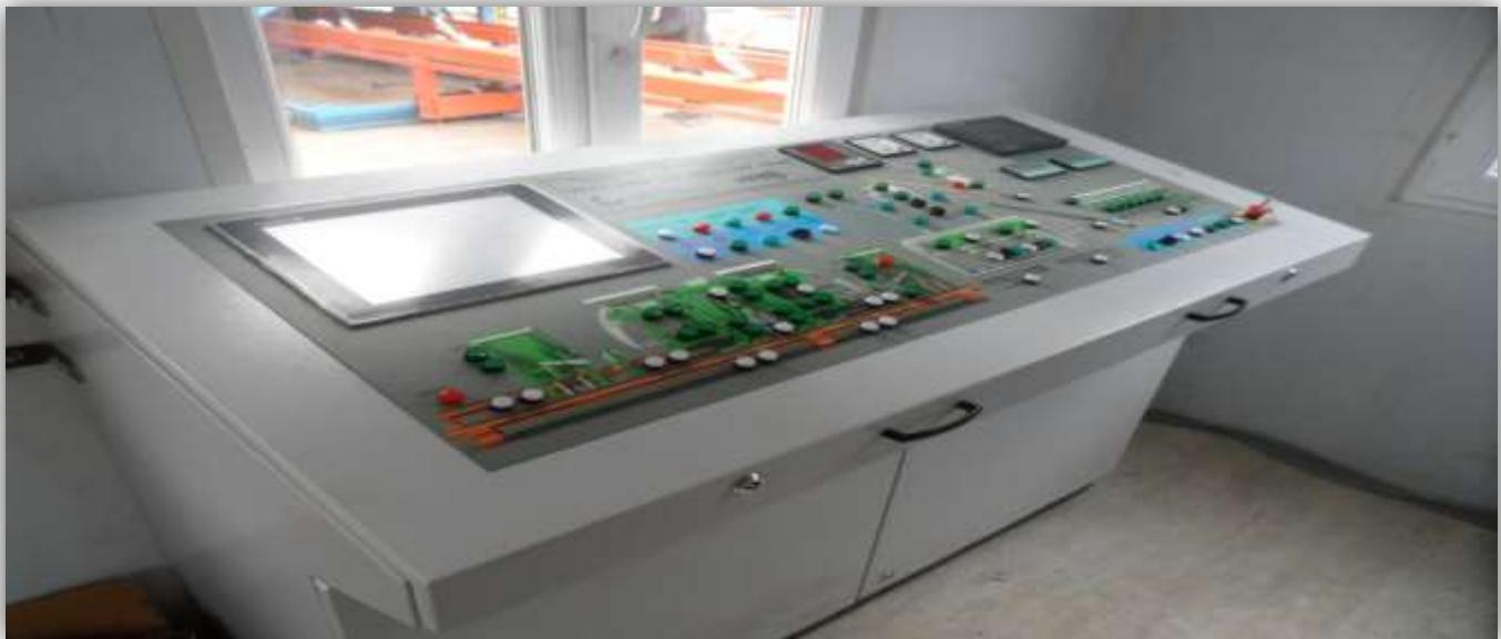
عبارة عن ام المصنع والتشغيل كاملا . جميع حركات الماكينة تتم عن طريق تحكم بأيدي هيدروليكيه . وجميع الوحدات بها حماية عالية. داخل الوحدة يوجد مراوح ضد الرطوبة. قطع الغيار المستعملة جميعها من نوع ( SIEMENS-TELEMECHANIC ) حسب الطلب الاختياري يمكنكم استخدام ( WIFI ) للتدخل الخرجي. تم البرمجة على اساس تثبيت العطل و يمكن التدخل من الخارج للصيانة والتعديل . يوجد ازرار توقف في حالات الطوارئ, ربوطات المكينة تأخذ الاوامر كلها عن طريق ( PLC ) .
