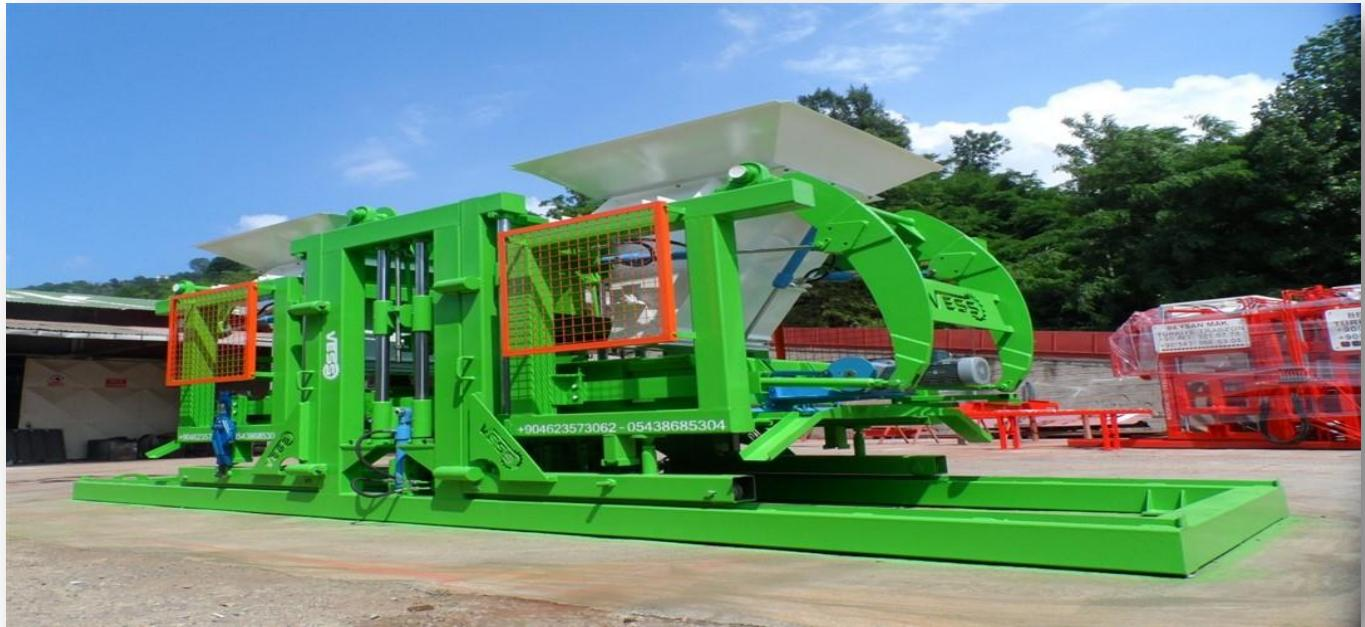
**عدد الهزاز السفلي :** 5.5 كيلووات بمحرك تركيب خاص سيرفو- محرك (فيبرو) // **هزاز التبريد:** لانها مصنوعة من امبير منخفض و لذلك لا يمكن ان يرتفع درجة حرارته / **عدد الهزاز العلوي :** محرك خاص (فيبرو) بقوة 2.2 كيلووات // **قدرة تبريد الهزاز:** 22.000(كجال) // **جميع الهزازات:** يعطي للمكينة اهتزاز بذبذبة قليلة من اجل التخميد ، يحصل على الخميد بواسطة الكوتشوك لمطاطة والنوابض.
