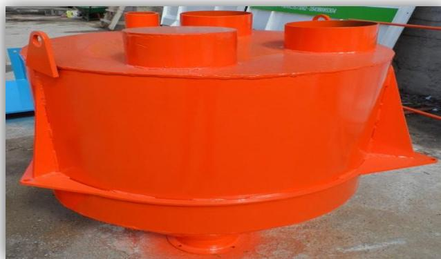
يتواجد في منتصف الخلطات لكي نتمكن من اضافة المواد المطلوبة للخلطات المختارة، وتحرك يمين يسار اسفل حلزونية الاسمنت وظيفتها وزن كل من الاسمنت والطلاء والمواد الاضافية ، يتم عملية الوزن عن طريقة خلية تحمل عدد 3 LOADCEL ( كل منها بسعة 1000 كجم ، طقطقة المشغل الميكانيكي نوع (WAM) ومستخدم فيها مفتاح صغير . وزن الماء عن طريق عداد الكتروني تنصب الماء حسب المنظومة المسجلة اما وزن المواد الاضافية سعة دلو الميزان 100 كجم و خزان وزن الصباغة 150 كليوغرام.
