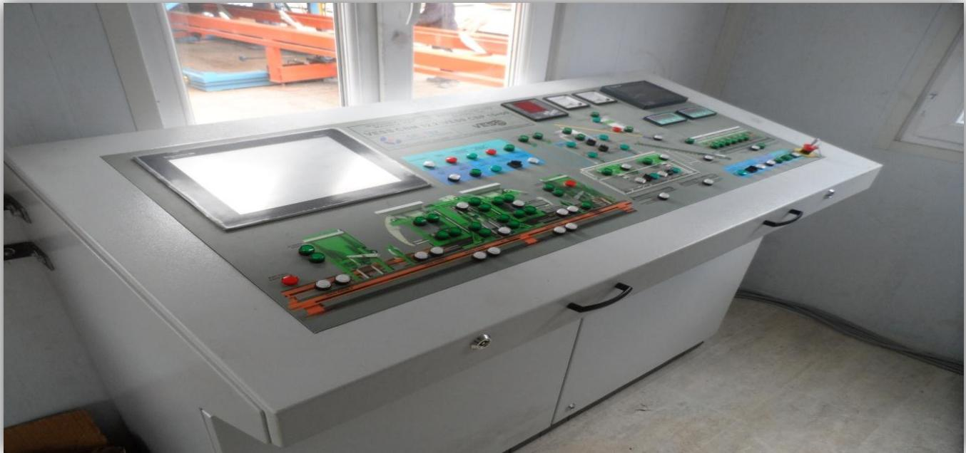
عبارة عن ام المصنع والتشغيل كاملا . جميع حركات الماكينة تتم عن طريق تحكم بأيدي هيدروليكيه . وجميع الوحدات بها حماية عالية. داخل الوحدة يوجد مراوح ضد الرطوبة. قطع الغيار المستعملة جميعها من نوع ( SIEMENS - TELEMECHANIC ) حسب الطلب الاختياري يمكنكم استخدام ( WIFI ) للتدخل الخرجي. تم البرمجة على اساس تثبيت العطل و يمكن التدخل من الخارج للصيانة والتعديل . يوجد ازرار توقف في حالات الطوارئ, ربوطات المكينة تأخذ الاوامر كلها عن طريق ( PLC ) .
