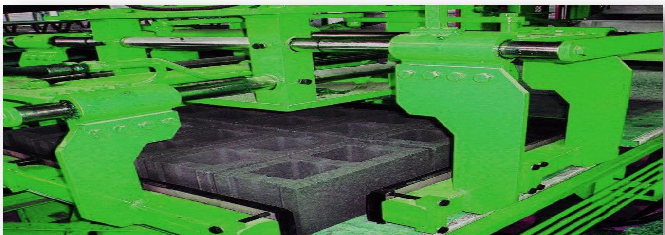
مهمتها تجميع المنتج الجاف وتستيفها على ظهر يورو باليت للتسويق ، لها ميزة حرارة 360 درجة التحرير ب بواسطة نظام ضغط هواء الذي يساهم في عدم تكسير الحجر وتحريك افقي وسفلي و يمين يسار بقوة محرك (محرك سيرفو), افقي وسفلي 11 (كيلوات) (يمين يسار 4(كيلوات) و يقوم بتحريك الرأس بقوة 2.2(كيلوات) يقوم بقياس الارتفاع عن طريق مقياس حساس ليزري.
