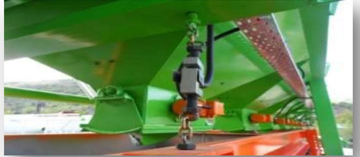
**خزان التوزين:** هو المسؤول على توزيع المواد الاولية المتدفقة من طرف خزان المواد الأولية. صنع من حديد الصاج داتسمك 5 مم.صنع على شكل ملتوي لتقوية مقاومته لتمدديد عمر عجلة يوجد عيار التحكم سمري لتدفق سير النقل الموجودة في خزان التوزين الذي يقلل من نزول كيمة المواد. يمكن تفكيك و عيار خزان التوزين.
