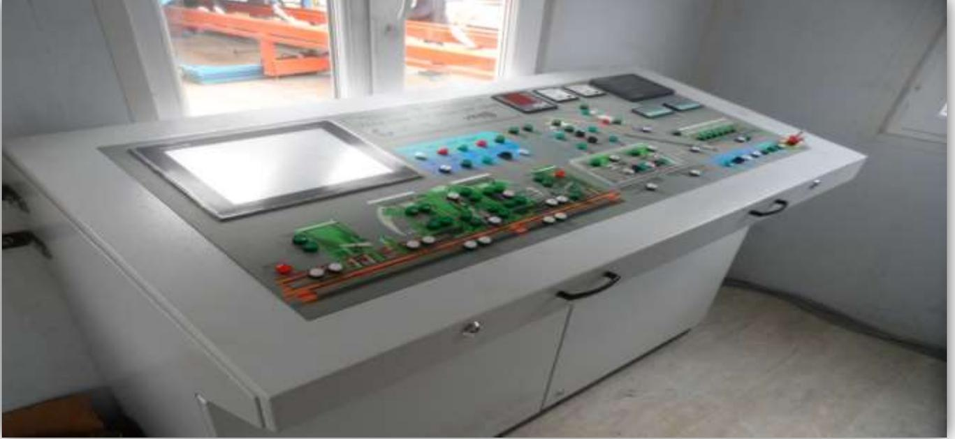
عبارة عن ام المصنع والتشغيل كاملا . جميع حركات الماكينة تتم عن طريق تحكم بأيادي هيدروليكية . وجميع الوحدات بها حماية عالية. داخل الوحدة يوجد مراوح ضد الرطوبة. قطع الغيار المستعملة جميعها من نوع (SIEMENS-TELEMECHANIC) حسب الطلب الاختياري يمكنكم استخدام (WIFI) للتدخل الخرجي. تم البرمجة على اساس تثبيت العطل و يمكن التدخل من الخارج للصيانة والتعديل . يوجد ازرار توقيف في حالات الطوارئ,ربوطات الماكينة تاخذ الاوامر كلها عن طريق (PLC) .
