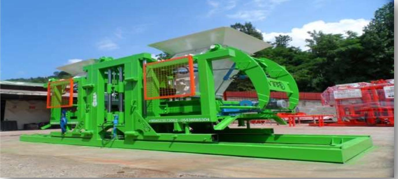
**عدد الهزاز السفلي : 4\*5.5 كيلوات** بمحرك تركيب خاص سيرفو- محرك ( فيبرو ) // **هزاز التبريد**: لانها مصنوعة من امبير منخفض و لذلك لا يمكن ان يرتفع درجة حرارته / **عدد الهزاز العلوي** : محرك خاص ( فيبرو ) بقوة 2\*2 (كيلوات) // قدرة تبريد الهزاز: 22.000(كجال) // جميع الهزازات: يعطي للمكينة اهتزاز بذبذبة قليلة من اجل التخمين ، يحصل على الخمين بواسطة الكوتشوك لمطاطة والنوابض .
