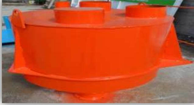
يتواجد في منتصف الخلطات لكي تتمكن من اضافة المواد المطلوبة للخلطات المختارة، وتتحرك يمين يسار اسفل حلزونة الاسمنت وظيفتها وزن كل من الاسمنت والطلاء والمواد الاضافية ، يتم عملية الوزن عن طريقة خلية تحميل عدد 3 (LLOADCEL) كل منها بسعة 1500 كجم ، طقطقة المشغل الميكانيكي نوع (WAM) ومستخدم فيها مفتاح صغير . وزن الماء عن طريق عداد الكتروني تصب الماء حسب المنظومة المسجلة اما وزن المواد الاضافية سعة دلو الميزان 200 كجم و خزان وزن الصبغة 200 كليونغرام.
