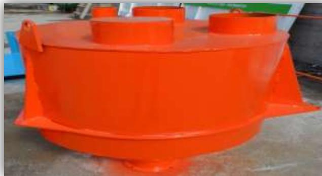
يتواجد في منتصف الخلطات لكي نتمكن من اضافة المواد المطلوبة للخلطات المختارة، وتحرك يمين يسار اسفل حزونة الاسمنت وظيفتها وزن كل من الاسمنت والطلاء والمواد الاضافية ، يتم عملية الوزن عن طريقة خلية تحمل عدد 3 (LOADCEL) كل منها 容量 500 كجم ، طقطقة المشغل الميكانيكي نوع (WAM) ومستخدم فيها مفتاح صغير . وزن الماء عن طريق عداد الكتروني تصب الماء حسب المنظومة المسجلة اما وزن المواد الاضافية سعة دلو الميزان 50 كجم و خزان وزن الصباغة 100 كليوغرام.
