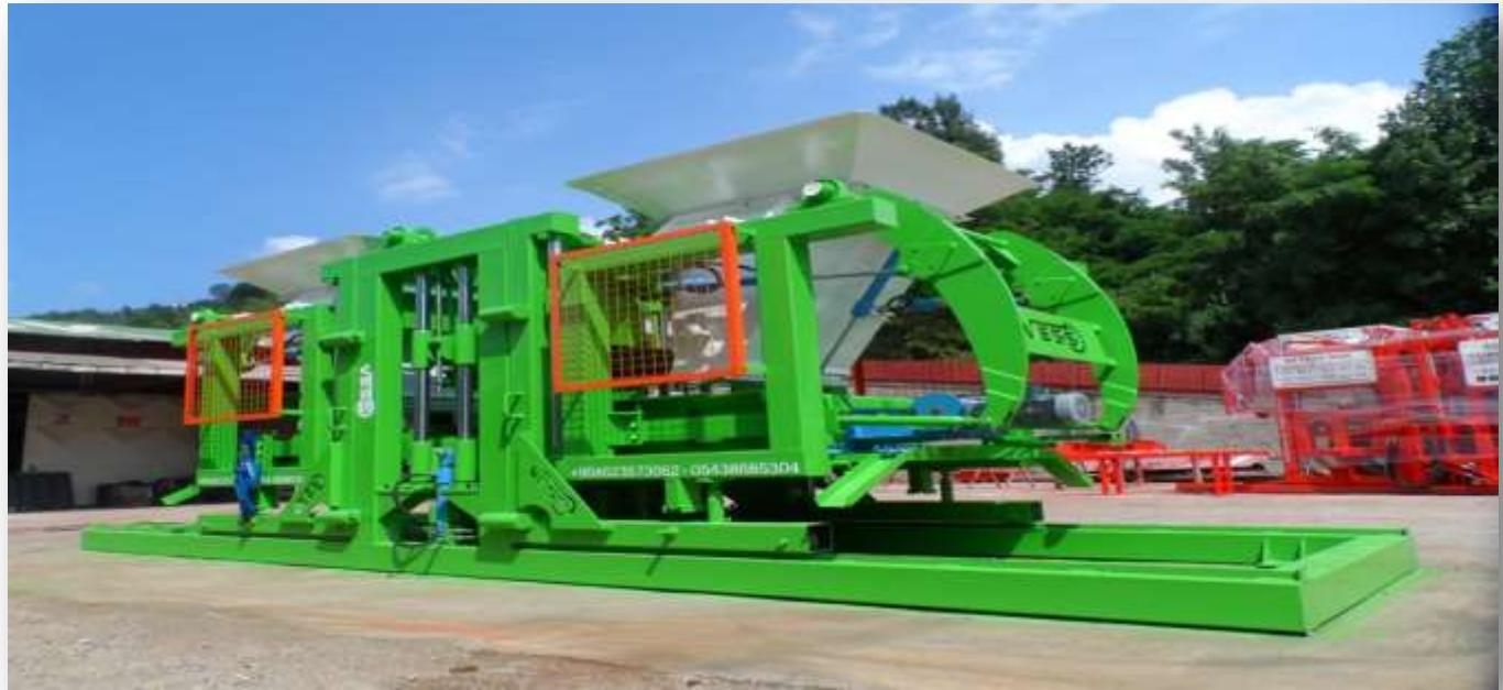
**عدد الهزاز السفلي : 7.5 كيلوات بمحرك تركيب خاص سيرفو- محرك (فيبرو) // هزار التبريد:** لأنها مصنوعة من أمبير منخفض و لذلك لا يمكن ان يرتفع درجة حرارته / **عدد الهزاز العلوي :** محرك خاص (فيبرو) بقوة 0.5\*2 (كيلوات) // قدرة تبريد الهزاز: 22.000(كجال) // جميع الهزازات: يعطي للمكينة اهتزاز بذبذبة قليلة من اجل التخميد ، يحصل على الخميد بواسطة الكوتشوك لمطاطة والنوابض .
