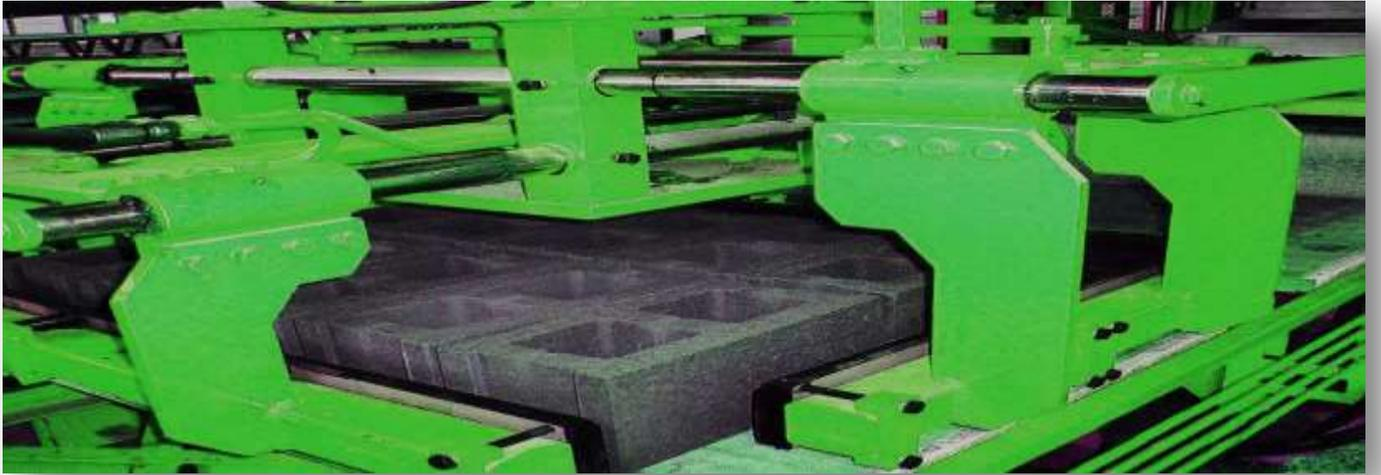
مهمتها تجميع المنتج الجاف وتستيفها على ظهر يورو باليت للتسويق ، لها ميزة حركة 360 درجة التحريك بواسطة نظام ضغط هواء الذي يساهم في عدم تكسير الحجر وتتحرك افقي وسفلي و يمين يسار بقوة محرك (محرك سيرفو) افقي وسفلي 15 (كيلوات) يمين يسار 5.5 (كيلوات) و يقوم بتحريك الراس بقوة 3(كيلوات) يقوم بقياس الإرتفاع عن طريق مقياس حساس ليزري
