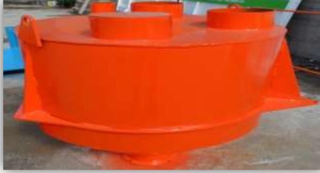
يتواجد في منتصف الخلطات لكي تتمكن من اضافة المواد المطلوبة للخلطات المختارة، وتتحرك يمين يسار اسفل حلزونة الاسمنت وظيفتها وزن كل من الاسمنت والطلاء والمواد الاضافية ، يتم عملية الوزن عن طريقة خلية تحميل عدد 3 (LLOADCEL) كل منها بسعة 1500 كجم ، طقطقة المشغل الميكانيكي نوع (WAM) ومستخدم فيها مفتاح صغير . وزن الماء عن طريق عداد الكتروني تصب الماء حسب المنظومة المسجلة اما وزن المواد الاضافية سعة دلو الميزان 200 كجم و خزان وزن الصباغة 200 كليونغرام.
