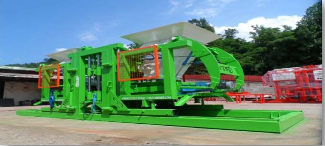
**عدد الهزاز السفلي : 4\*5.5 كيلوات** بمحرك تركيب خاص سيرفو- محرك (فيبرو) // **هزاز التبريد**: لانها مصنوعة من امبير منخفض و لذلك لا يمكن ان يرتفع درجة حرارته / **عدد الهزاز العلوي** : محرك خاص (فيبرو) بقوة 2\*2 (كيلوات) // قدرة تبريد الهزاز: 22.000(كجال) // جميع الهزازات: يعطي للمكينة اهتزاز بذبذبة قليلة من اجل التخميد ، يحصل على الخמיד بواسطة الكوتشوك لمطاطة والنوابض .
