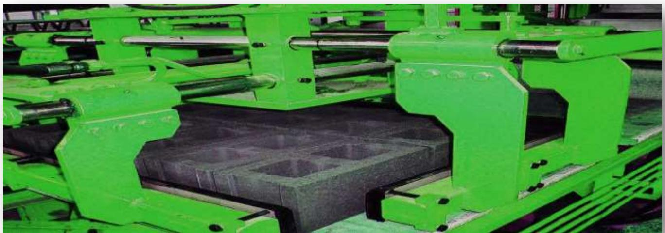
مهمتها تجمیع المنتج الجاف وتستيفها على ظهر يورو باليت للتسويق ، لها میزة حرکة 360 درجة التحریک بواسطہ نظام ضغط هواء الذي يساهم في عدم تكسير الحجر وتحريك افقي وسفلي و يمين يسار بقوة محرك (محرك سيرفو)، افقي وسفلي 15 (كيلووات) (يمين يسار 5.5 كيلووات) و يقوم بتحريك الراس بقوة 3(كيلووات) يقوم بقياس الارتفاع عن طريق مقياس حساس ليزري
