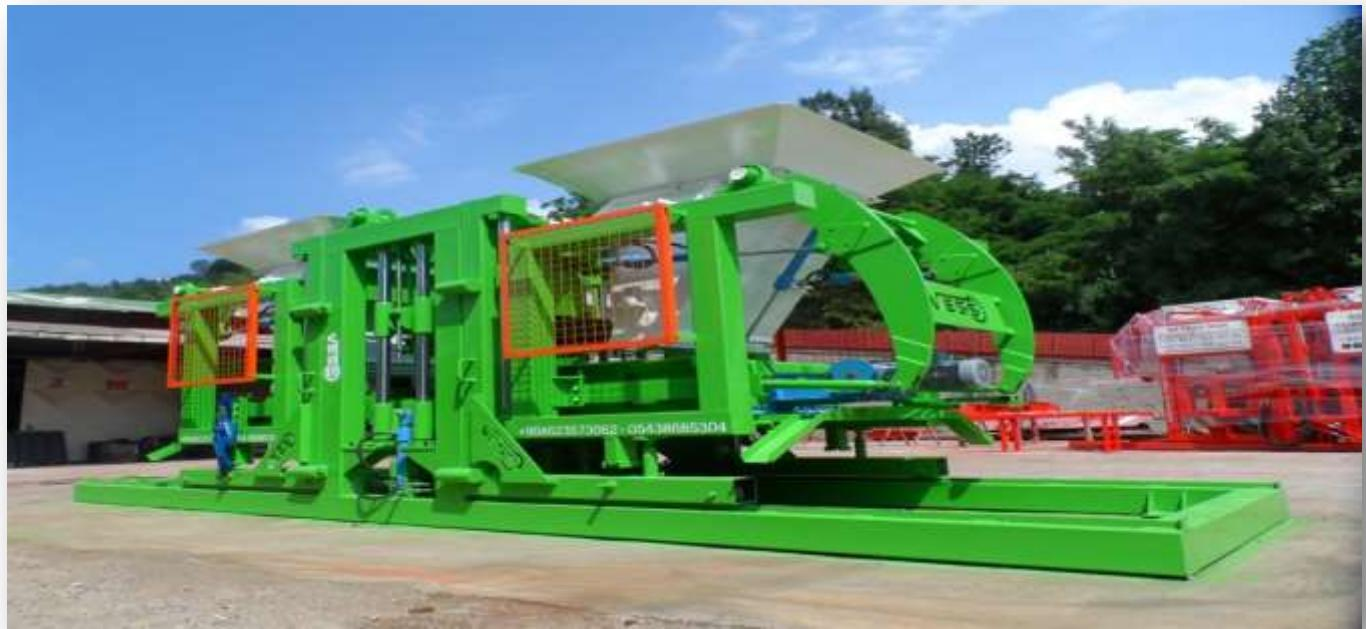
**عدد الهزاز السفلي :** 7.5 كيلووات بمحرك تركيب خاص سيرفو- محرك (فيبرو) // **هزاز التبريد:** لانها مصنوعة من اميرير منخفض و لذلك لا يمكن ان يرتفع درجة حرارته / **عدد الهزاز العلوي :** محرك خاص (فيبرو) بقوة 2.2\*4 (كيلووات) // **قدرة تبريد الهزاز:** 22.000(كجال) // **جميع الهزازات:** يعطي للمكينة اهتزاز بذبذبة قليلة من اجل التخميد ، يحصل على الخميد بواسطة الكوتشوك لمطاطة والنوابض.
